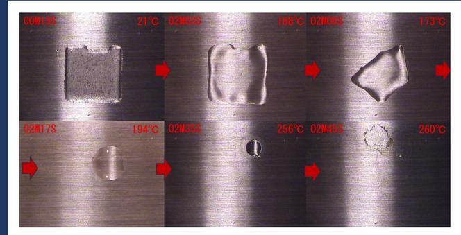
無洗浄タイプと比べ、フラックス残量を大幅に低減し、超低残渣を実現
