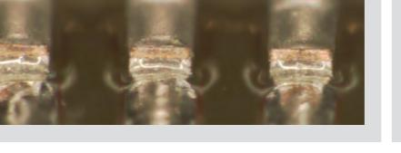
マスク厚: 0.15mm 部品: 0.65mm ピッチ QFP Part: 0.65 mm pitch QFP Mask thickness: 0.15 mm
