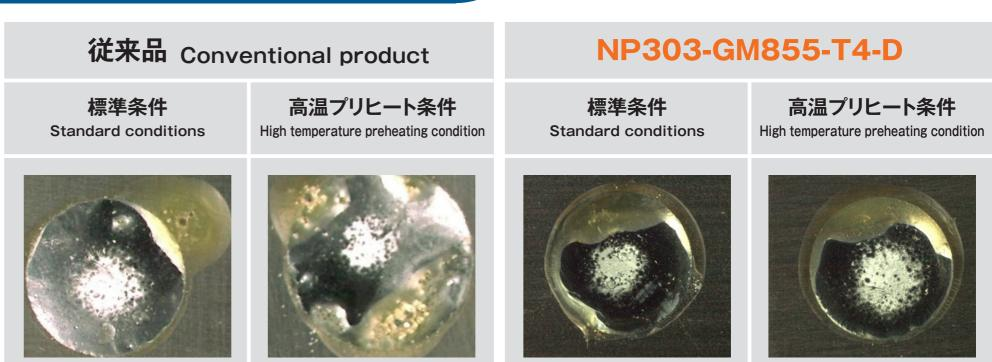
メタルマスク開口部:Φ6.5mm, メタルマスク厚: 0.1mm Part of metal mask opening: \$\phi 6.5 mm\$, Metal mask thickness: 0.1 mm
